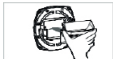
4. Po wysuszeniu zamontować regulator przepływu.
